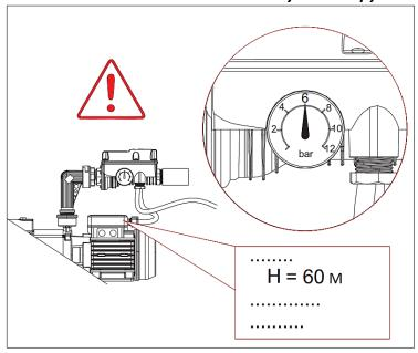
Внимание! Устройство BRIO устанавливается в систему с погружным или поверхностным насосом производительностью не менее 2,5 литр/мин.
