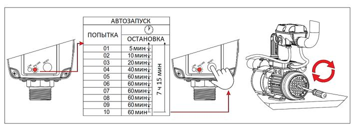
В случае, если насос постоянно выключается и сразу же перезапускается: необходимо проверить герметичность системы, либо установить после устройства управления насосом гидроаккумулятор небольшого объема 5-8 литров.
