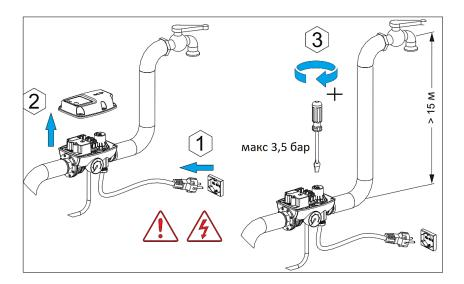
После запуска насоса следует открыть наиболее высоко расположенный кран и проверить идет ли через него постоянный поток воды. Если поток непрерывный, то процедура ввода в эксплуатацию завершена. При прерывистом потоке необходимо дать насосу поработать некоторое время, нажав кнопку перезапуска.
