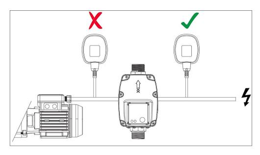
Внимание! Монтаж электрических соединений производить через клеммы, поставляемые в комплекте с устройством. При монтаже клемм, необходимо следить за тем, чтобы винты крепления кабеля не оказались в прилегающем положении.
