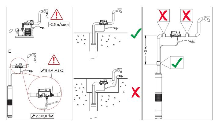
Внимание! При монтаже и эксплуатации устройства BRIO, применение рычажных газовых ключей категорически запрещено.
